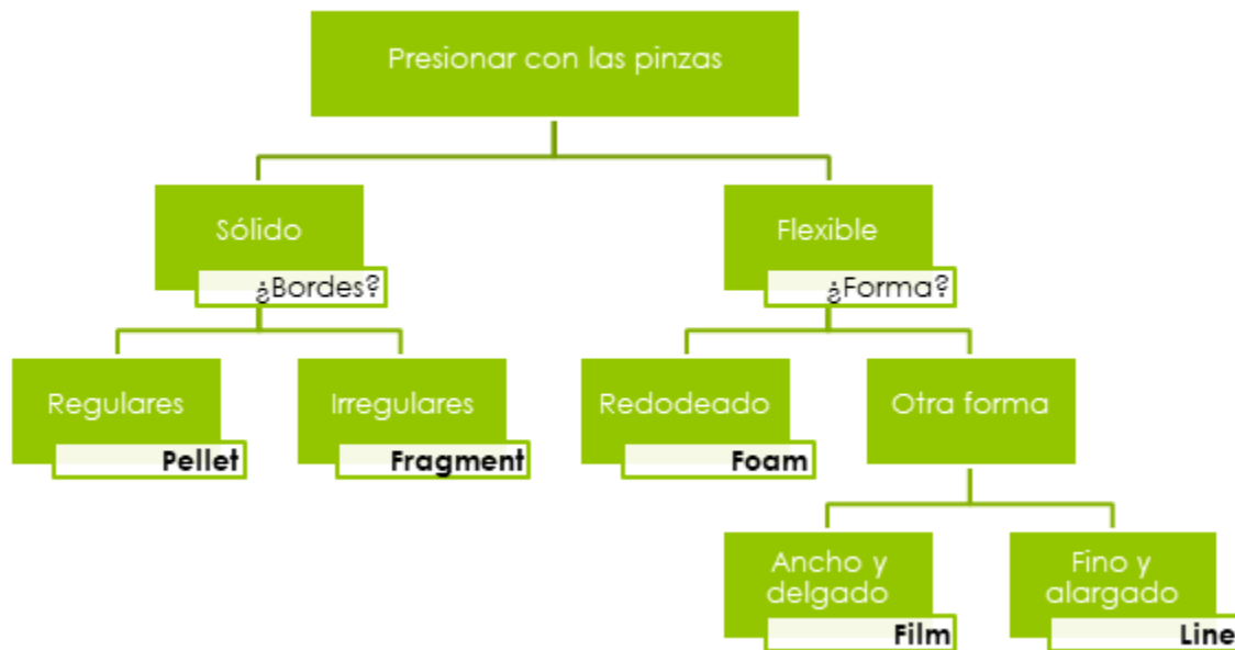
Figura 42. Diagrama de clasificación de partículas de microplásticos y mesoplásticos mediante análisis visual en microscopio estereoscópico (adaptado de GESAMP 2019).
