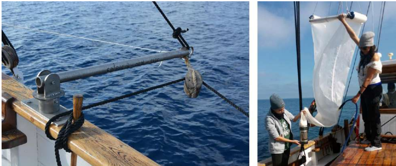
Figura 39. Izquierda: tangón lateral instalado en el Else para soportar el arrastre de la red de muestreo. Derecha: limpieza de la red y recogida de la muestra en el colector con ayuda de la bomba de agua marina a presión.
